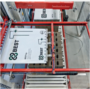
Configuration with sliding strapping bayonet Konfigurácia s výsuvným páskovacím bajonetom
